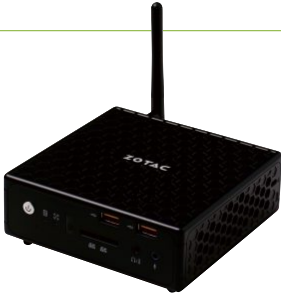
Zotac Zbox Nano: Der Mini-PC kühlt den Prozessor passiv und arbeitet daher geräuschlos.
