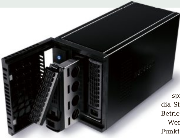
Hot Swap: Festplatten lassen sich im laufenden Betrieb wechseln. Hier das ReadyNAS 102 von Netgear (Bild C)
