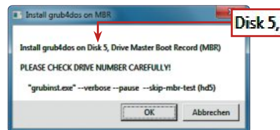
Grub4Dos installieren: Hier wird Ihnen das Laufwerk angezeigt, auf dem Grub4Dos installiert wird. Vergleichen Sie die angegebene Laufwerknummer mit der in der Laufwerkliste von RMPrepUSB (Bild D)
