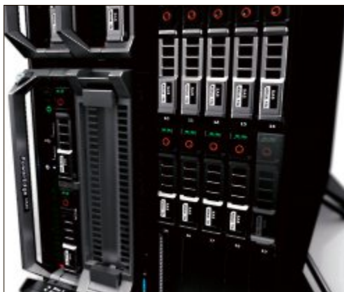
Data Center in a Box: Mit Power Edge VRTX bietet auch Dell eine Converged Infrastructure für KMU an (Bild C)
