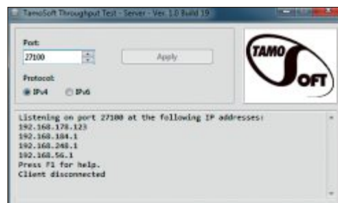
Throughput Test 1.0: Auf dem Client tragen später Sie die erste IP-Adresse ein, die Ihnen der Server hier anzeigt, im Beispiel 192.168.178.123 (Bild C)
