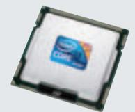
Die zweiten Generation der Core-i-Baureihe vereint CPU und GPU zu einer heterogenen Multicore-CPU
