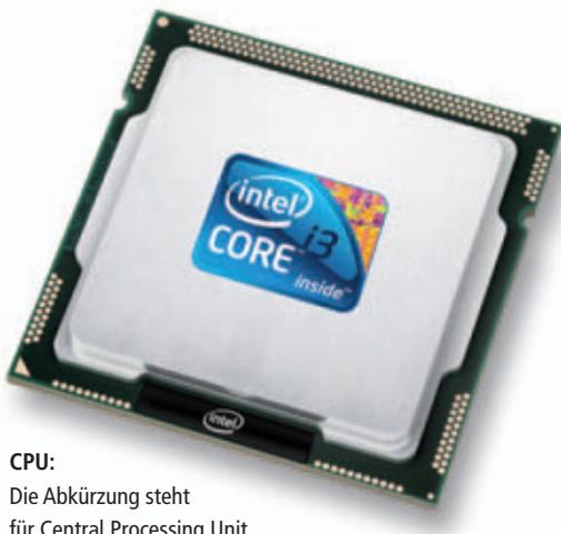
**CPU:** Die Abkürzung steht für Central Processing Unit, auf Deutsch Hauptprozessor (Bild A)
