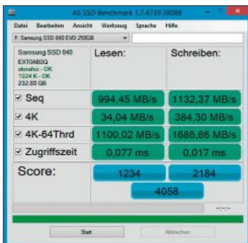
**Rapid-Mode:** Normale SSDs schreiben etwa 500 MByte/s. Die Caching-Technik Rapid-Mode verhilft der Samsung 840 Evo zu einer Schreibrate von 1'132,37 MBytes/s (Bild B)
