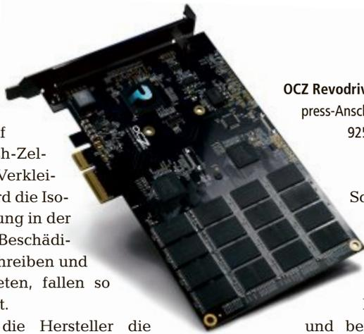
**OCZ Revodrive:** Die SSD wird am PCI-Express-Anschluss betrieben und kann so 925 MByte/s schreiben (Bild C)
