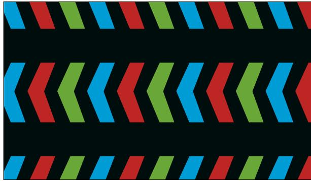
**Winkelförmige Subpixel:** Bei S-IPS-Paneln sind die Subpixel winkelförmig und ineinander verschoben. Das erhöht den Betrachtungswinkel (Bild G)
