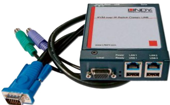
4 KVM-over-Ethernet-Switch: Ein solcher Switch mit Netzwerkanschluss leitet die Bildschirmausgabe über das Netzwerk oder Internet weiter.
