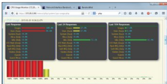
CPU Usage Monitor: Hohe Belastungen einzelner CPU-Kerne fallen dem Admin sofort ins Auge.
