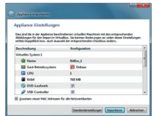
Virtuelle PCs importieren: Einen fertigen virtuellen PC im OVA-Format importieren Sie mit einem Doppelklick in Virtual Box (Bild G)
