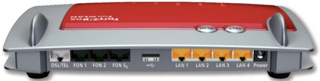
Fritzbox nicht erreichbar: Die Fritzbox hat auf der Rückseite keinen Reset-Knopf. Über eine bestimmte Adresse haben Sie bei Problemen trotzdem immer Zugriff auf den Router (Bild C)
