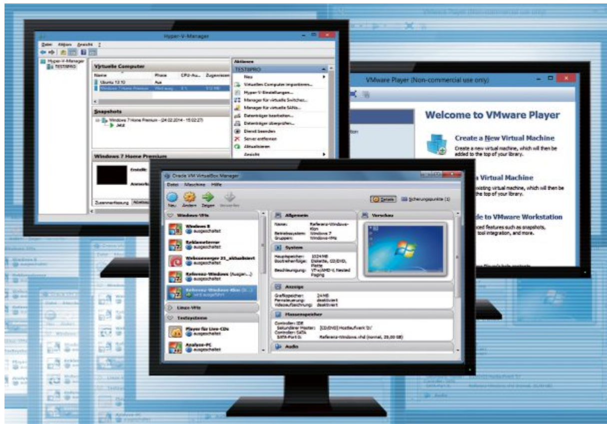
Virtuelle PCs: Die Virtualisierer Virtual Box 4.3.8, Vmware Player 6.0.1 und Hyper-V laufen in einem Fenster auf dem echten PC (Bild A)
