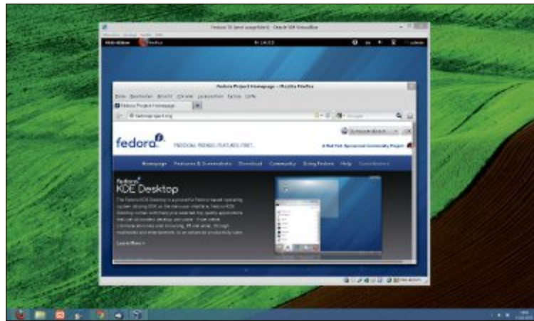
Fedora: Diese virtuelle Maschine mit Fedora liegt vollständig auf dem NAS-Server. Der virtuelle PC wurde direkt vom NAS-Server über das Netzwerk gebootet (Bild A)
