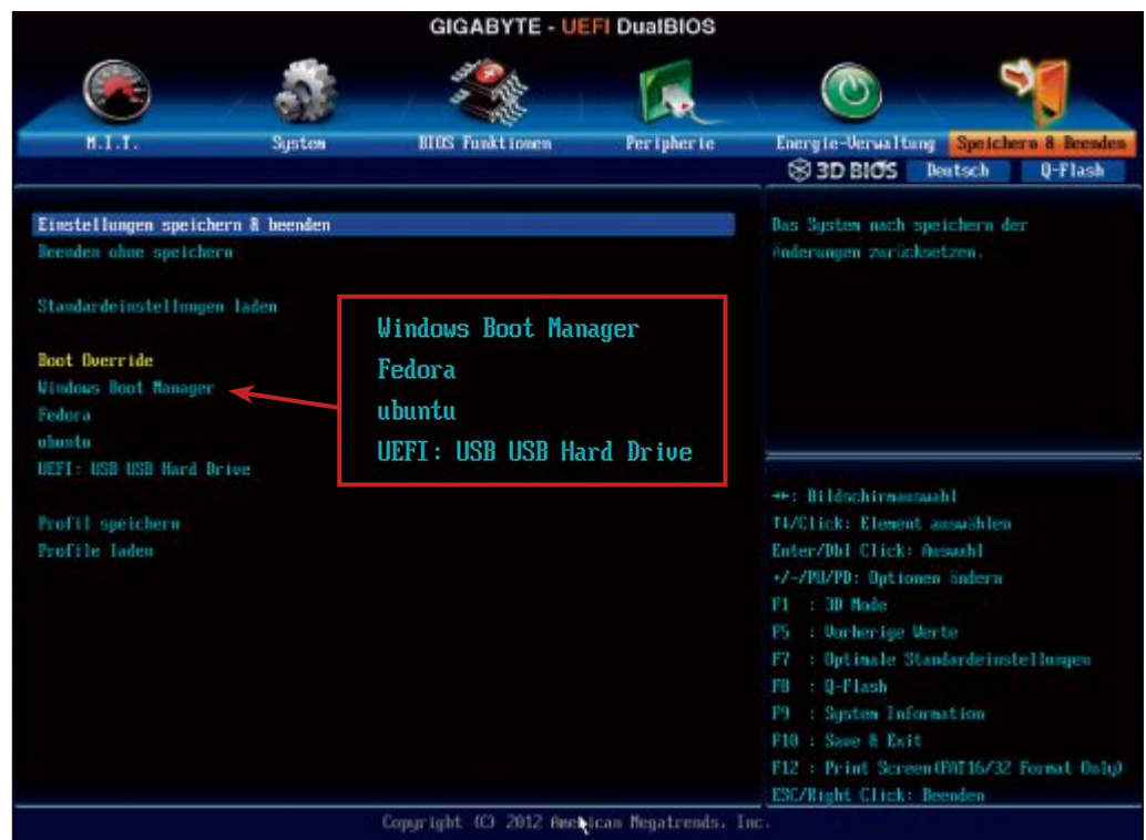
UEFI-Boot-Menü: Die installierten UEFI-Systeme sind als Startoption in UEFI eingetragen. Ganz so, als handle es sich um ein gewöhnliches Laufwerk – etwa eine Festplatte oder einen USB-Stick (Bild D)
