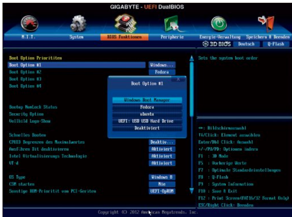
Multi-Boot mit UEFI: Hier legen Sie fest, in welcher Reihenfolge die Betriebssysteme booten sollen. UEFI unterscheidet dabei nicht zwischen USB-Sticks, Festplatten, Partitionen und DVD-Laufwerken (Bild A)
