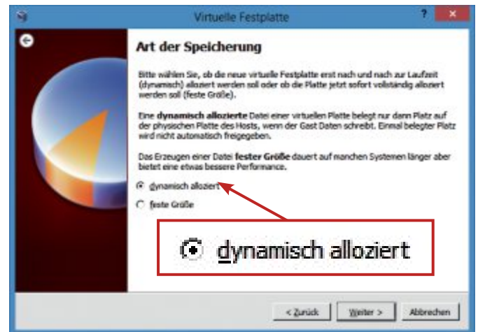
Dynamisches Wachstum: Liegt die virtuelle Festplatte auf dem NAS-Server, dann sollte die Datei dynamisch wachsen. Das reduziert die Ladezeiten beim Start (Bild G)
