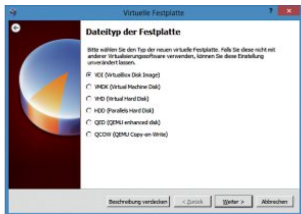
Virtual Box Disk Image: Wenn Sie die virtuellen Maschinen auf dem NAS speichern, wählen Sie als Dateityp für die virtuelle Festplatte „VDI“ aus (Bild F)
