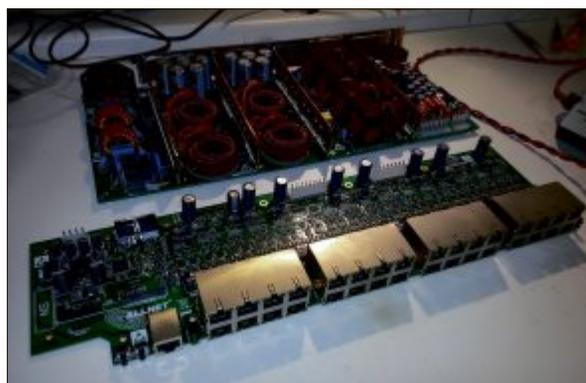
**Mid-Span Insertion Panel:** Diese Geräte werden in der Regel zwischen einem Switch und den Power-Devices geschaltet. Dabei sind zwischen sechs und 24 Kanälen durchaus üblich.
