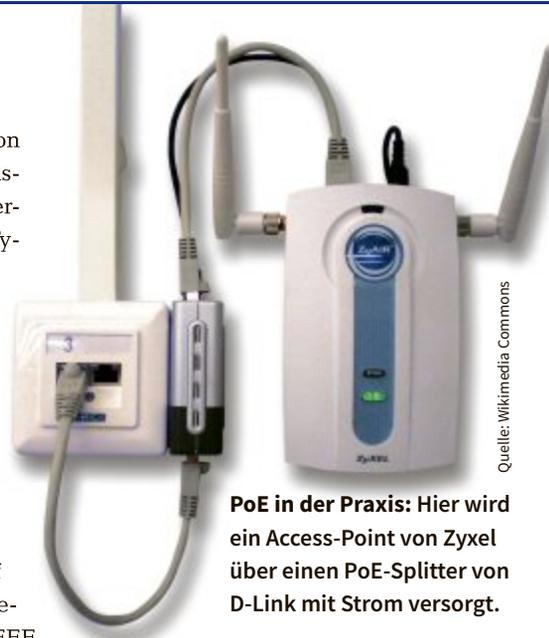
PoE in der Praxis: Hier wird ein Access-Point von ZyXel über einen PoE-Splitter von D-Link mit Strom versorgt.
