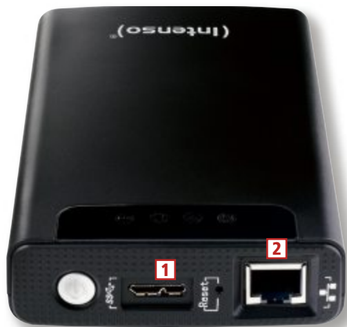
Schnittstellen: Die Intenso Memory 2 Move hat ausser einem USB-3.0-Anschluss (1) auch einen Ethernet-Anschluss (2) (Bild B)
