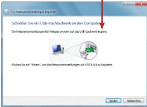
WLAN-Profil sichern: Unter Windows 7 speichert dieser Assistent das WLAN-Profil samt Passwort auf einem USB-Laufwerk (Bild B)
