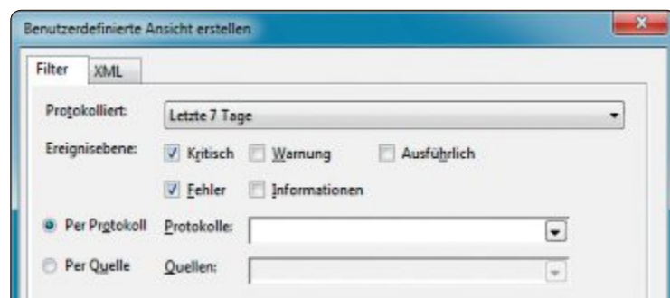
Ereignisanzeige filtern: In diesem Dialogfenster legen Sie fest, welche Einträge Ihnen in der Ereignisanzeige angezeigt werden. Mit „Kritisch“ und „Fehler“ sehen Sie nur die wichtigen Einträge (Bild E)
