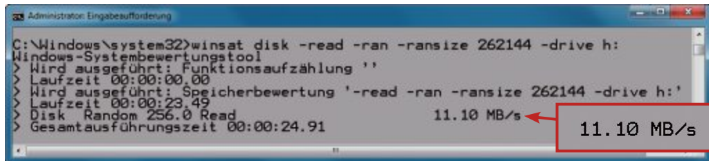
Tipp 11 – Festplatten-Benchmark: Windows hat mit Winsat ein verstecktes Benchmark-Tool an Bord. In diesem Beispiel stellt die USB-Festplatte mit einer Lesedatenrate von 11 MByte/s keine Temporekorde auf
