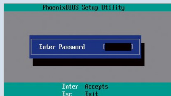
Systempasswörter: Ein BIOS-Passwort ist ein einfacher, aber effektiver Schutz vor bootfähigen Live-CDs (Bild H)
