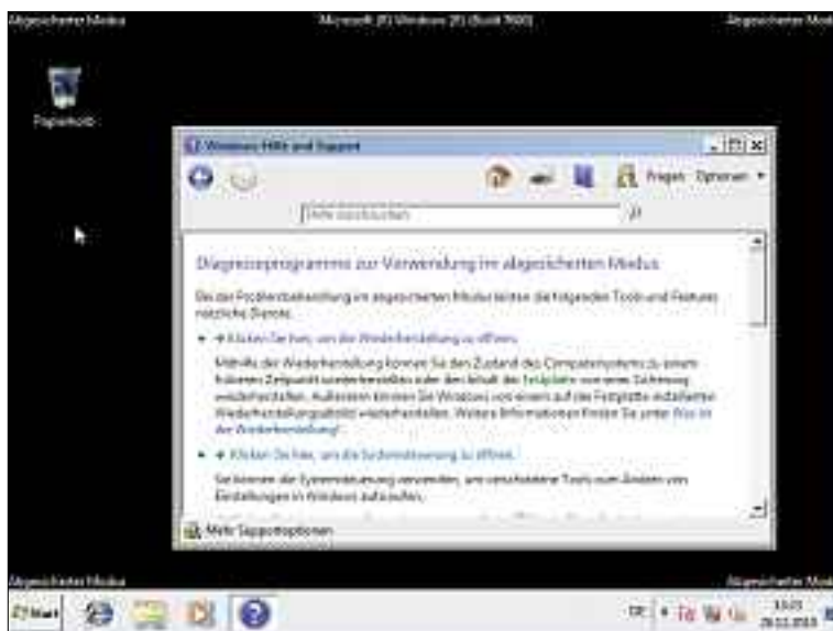
Abgesicherter Modus: Mit dieser Einstellung lädt Windows nur die wichtigsten Treiber und keine Autostart-Programme. Damit sieht das System zwar spartanisch aus – eignet sich aber, um Probleme zu beheben (Bild C).
