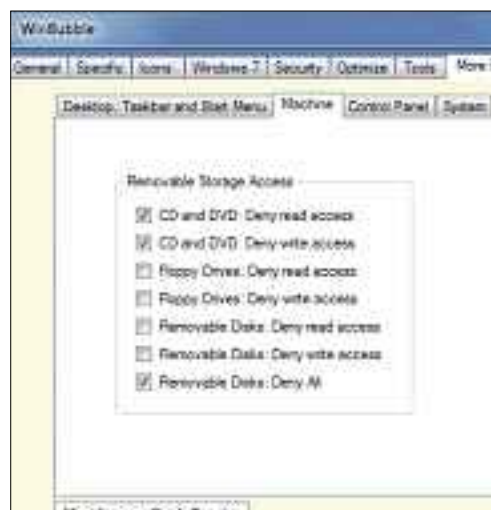
Zugriff auf USB-Sticks verweigern: Im Register "More Policies" auf dem Reiter "Machine" belegen Sie Wechsel-datenträger mit einem Lese- und Schreibschutz (Bild F).
