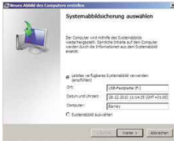
Systemabbild wiederherstellen: Eine komplette Kopie der Systemlaufwerke stellen Sie immer über die Windows Recovery Environment wieder her (Bild I).
