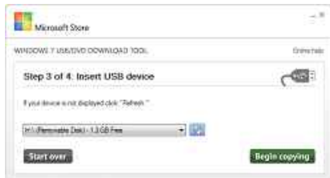
Windows 7 USB/DVD Download-Tool: Das Programm erstellt einen bootfähigen USB-Stick mit den Installationsdateien von Windows 7 (Bild C).
