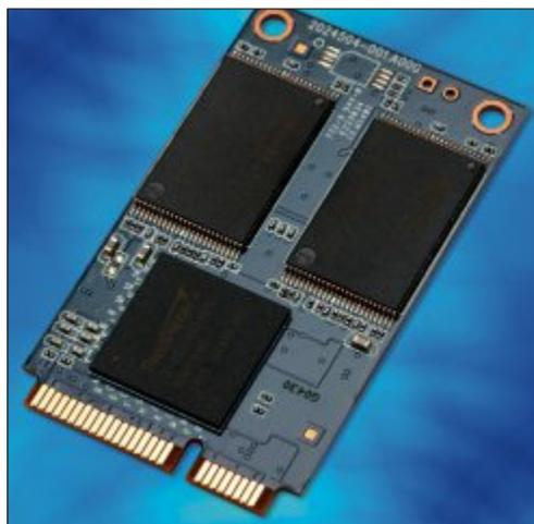
**Begrenzter Speicherplatz:** Da auf die Vorder- und Rückseite der Platine nur vier bis fünf Speicherbausteine passen, ist die maximale Grösse der SSD durch die Speicherkapazität der Flash-Bausteine limitiert (Bild D)
