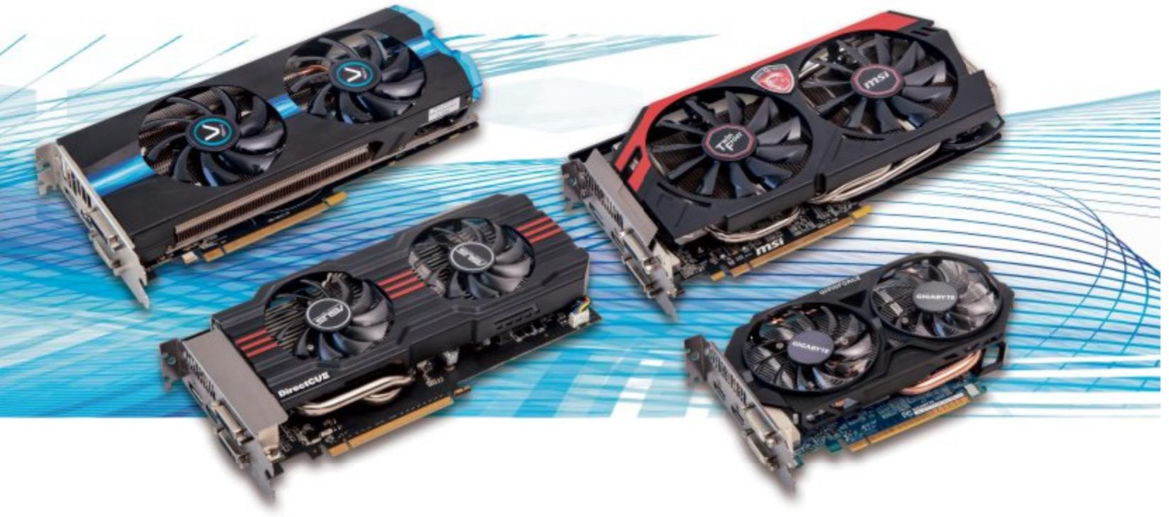
gestattete DirectCU-Kühler (Bild A). Er gewährleistet, dass die Temperatur der Grafikprozessoren auch in extremen Stress-Situationen 60 Grad Celsius kaum übersteigt. Mit den beiden nebeneinander angeordneten Lüftern gibt er ausserdem die Baulänge der Karten vor, die bei der GTX 660 knapp 26 cm beträgt.
