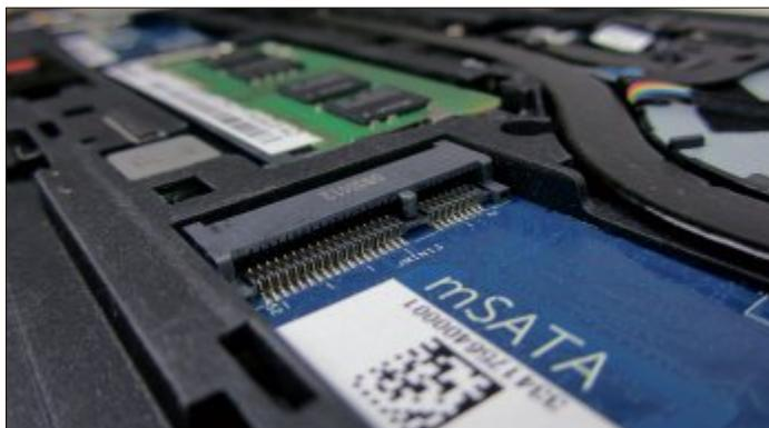
**Dell Latitude E7240:** Das Notebook ist bereits mit einem mSATA-Anschluss ausgestattet und lässt sich daher mit einer schnellen Mini-SSD aufrüsten (Bild C)
