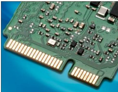
**mSATA-Anschluss:** Die Kontaktleiste einer mSATA-SSD entspricht mechanisch der eines Mini-PCIe-Anschlusses (Bild B)
