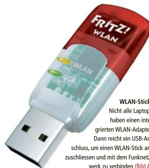
**WLAN-Stick:** Nicht alle Laptops haben einen integrierten WLAN-Adapter. Dann reicht ein USB-Anschluss, um einen WLAN-Stick anzuschliessen und mit dem Funknetzwerk zu verbinden (Bild A)
