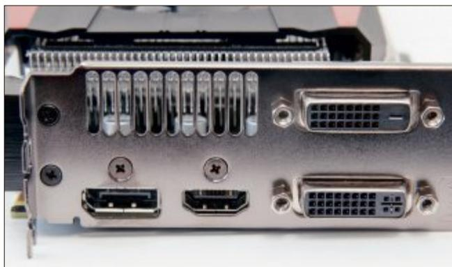
Asus R9 270X DirectCU II OC: Das doppelte Frontblech hat Platz für alle gebräuchlichen Monitoranschlüsse und eine Reihe von Lüfterschlitzen (Bild B)
