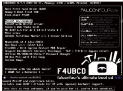
**Falcon Four's Ultimate Boot CD:** In dieser Boot-CD sind ein kleines Windows, ein kleines Linux und ein Tool zur Partitionsverwaltung integriert (Bild F)
