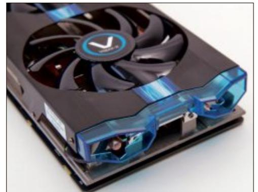
**Vapor R9 270X:** Der Sapphire-Alukühler mit zwei Lüftern erbringt die geringste Kühlleistung unter den 270X-Karten im Test. Die genügt jedoch durchaus (Bild E)
