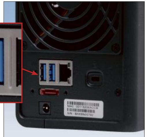
**USB-3.0-Anschlüsse:** Die schnelle USB-Schnittstelle findet sich derzeit nur bei den teureren NAS-Modellen – hier das DS212+ von Synology (Bild H)
