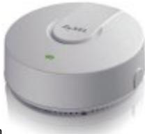
**NWA1121-NI:** Mit mehreren flexiblen Betriebsmodi. und erreicht Datenraten von bis zu 300 Mbps. Er ist gleichermaßen für verteilte und Stand-alone-WLAN-Deployments geeignet, etwa in KMU, Gastronomie, Hotellerie und im Bildungswesen. *ph*
