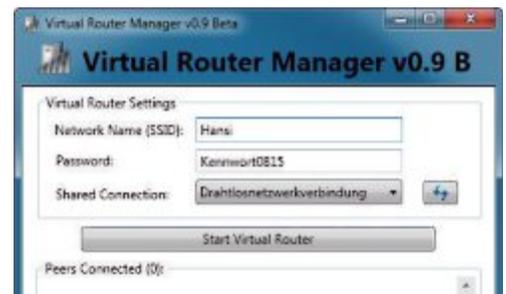
PC als WLAN-Repeater: Windows 7 arbeitet als WLAN-Sender und -Empfänger und erhöht so die Reichweite des Netzes (Bild E)
