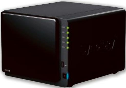
**RAID 5:** Bei 4-Bay-Systemen verwenden Sie RAID Level 5. Es ist so sicher wie RAID 1 und es lassen sich 75 Prozent der Festplattenkapazität nutzen (Bild D)
