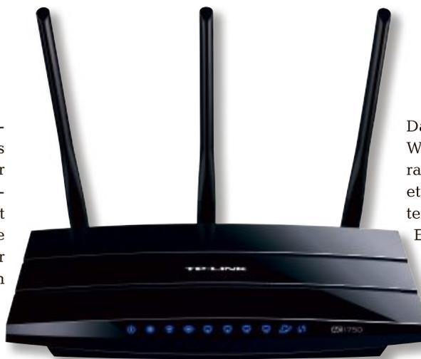
**TP-Link Archer C7:** Angeblich schafft dieser Router eine Datenrate von 1'750 MBit/s. Tatsächlich werden aber nur die maximalen Datenraten zweier eigenständiger Funknetze addiert, 1'300 MBit/s bei WLAN-ac und 450 MBit/s bei WLAN-n (Bild B)
