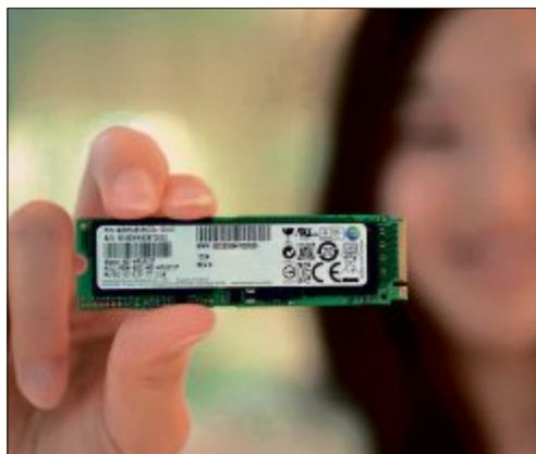
M.2: Der neue Formfaktor für SSDs namens M.2 ist vor allem für Ultrabooks und Tablets gedacht. Die SSDs sind nur 80 Millimeter lang und 22 Millimeter schmal (Bild J)
