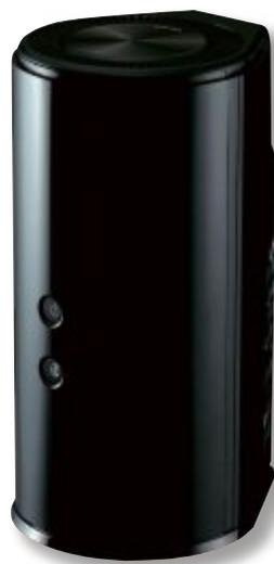
**D-Link AC1200:** Das „AC1200“ lässt vermuten, dass das WLAN-ac-Funknetz dieses Routers 1'200 MBit/s schnell ist. Das stimmt aber nicht, es sind nur 867 MBit/s (Bild C)
