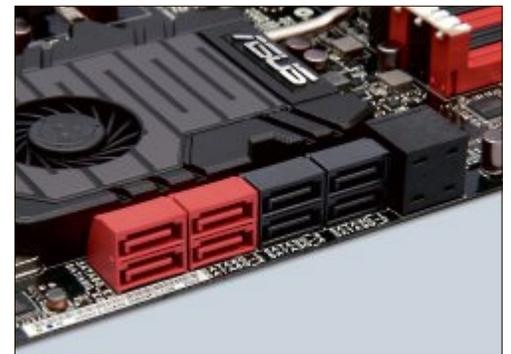
**SATA-Schnittstelle:** Bislang werden SSDs an SATA-III-Schnittstellen (rot) angeschlossen. Die schaffen aber höchstens 600 MByte/s und bremsen moderne SSDs aus (Bild H)
