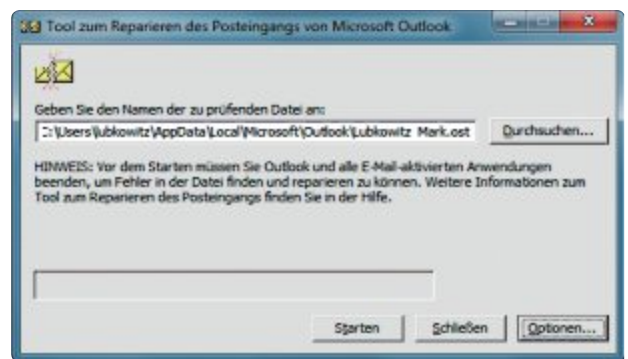
Tipp 4 – Outlook-Datei reparieren: Dieses kleine Programm, das in Outlook dabei ist, repariert Ihre persönliche Ordnerdatei von Outlook
