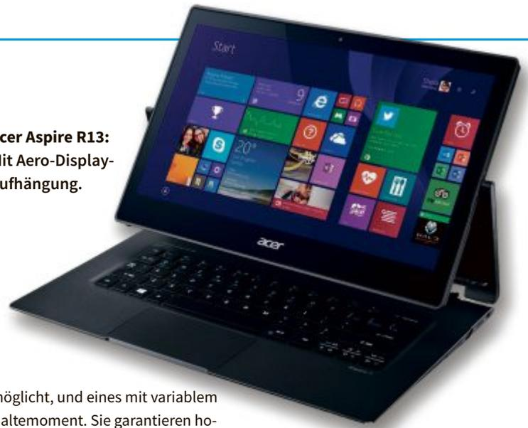
möglicht, und eines mit variablem Haltemoment. Sie garantieren hohe Stabilität bei der Touch-Eingabe und unterstützen zugleich sechs unterschiedliche Einsatzmodi. Damit verbindet das neue Modell die Vorteile von Notebook und Tablet in einem Gerät und erlaubt eine individuelle Anpassung an die jeweiligen Nutzungsgewohnheiten und Einsatzszenarien. Die verschiedenen Modi lassen den Anwendern grösstmögliche Freiheit.
