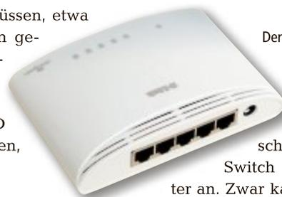
**DGS-1005D von D-Link:** Der Switch erzielt dank Full-Duplex Datenraten von bis zu 2 GBit/s (Bild E)
