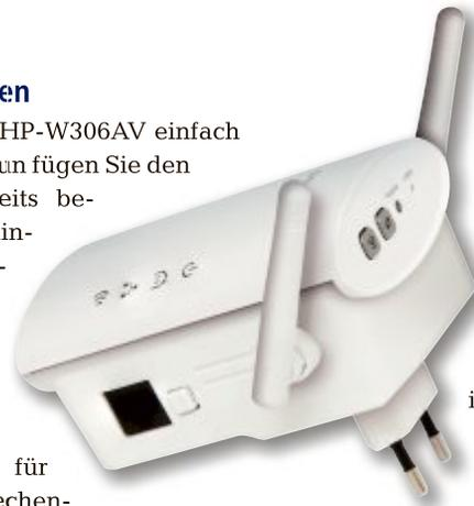
**D-Link DHP-W306AV:** Der Power-LAN-Adapter fügt Ihrem Netzwerk einen WLAN-Access-Point hinzu (Bild J)
