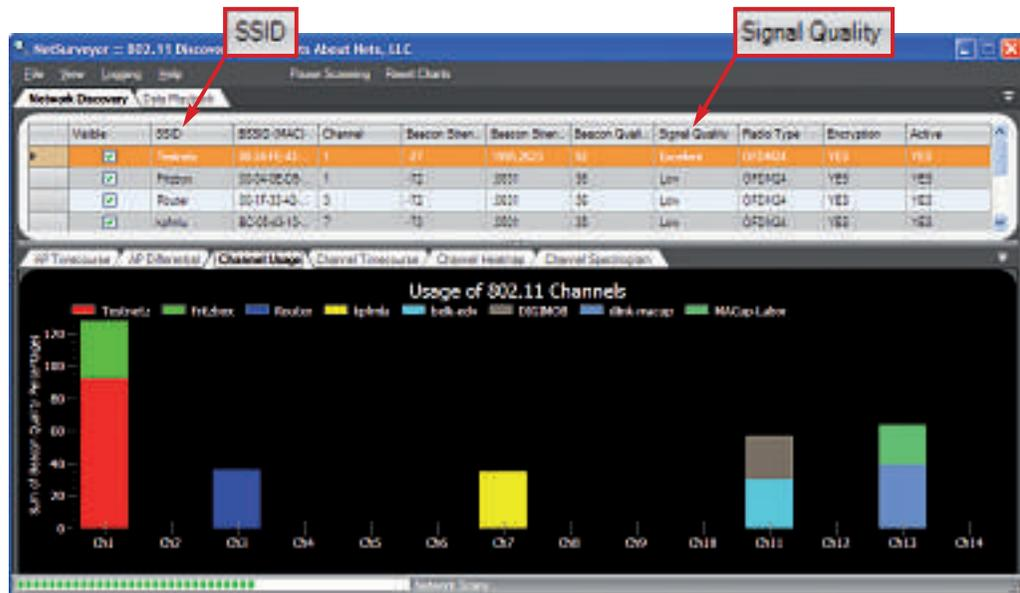
Net Surveyor 2.0: Oben sehen Sie die Eigenschaften der gefundenen Funknetze. Unten sehen Sie, welches Funknetz welchen Kanal belegt (Bild E).
