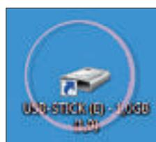
**Tipps 5 – Desktop-Verknüpfung:** Sobald ein USB-Stick mit dem Rechner verbunden wird, erstellt Desk Drive 1.8.2 auf dem Desktop eine Verknüpfung zu dem Stick und markiert sie mit einem Kreis.
