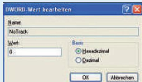
3 Klicken Sie im rechten Fenster mit der rechten Maustaste auf den Eintrag *NoTrack* und wählen Sie **Ändern**. Setzen Sie den Wert von 1 auf 0. Nach einem Neustart des Rechners protokolliert Word die Zeit, in der ein Dokument geöffnet ist.
