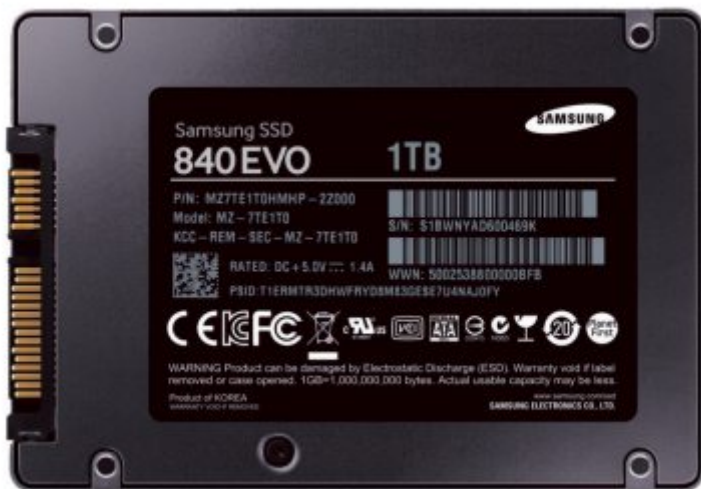
4 Samsung 840 Evo: Die Leseleistung dieser Baureihe bricht teils massiv ein. Ein kostenloses Tool des Herstellers behebt die Probleme.
