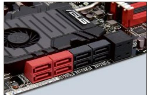
**SATA III:** SSDs gehören an den schnellen SATA-III-Anschluss. Der ist hier auf dem Mainboard rot gekennzeichnet (Bild B)
