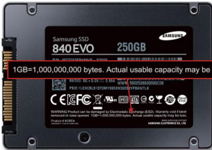
**Speicherplatz:** Der Hersteller rechnet 1 Gigabyte als eine Milliarde Byte. Diese 250-GB-SSD hat in Windows nur 232 GByte (Bild D)
