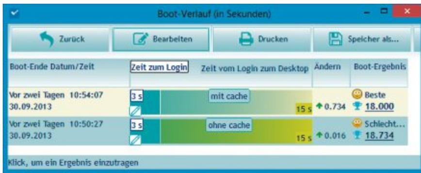
**Windows startet gleich schnell:** Die Messungen mit Boottracer 4.5 (kostenlos, [www.greatis.com/boottracer](http://www.greatis.com/boottracer)) zeigen, dass der Software-Cache den Windows-Start nicht beschleunigt (Bild D)
