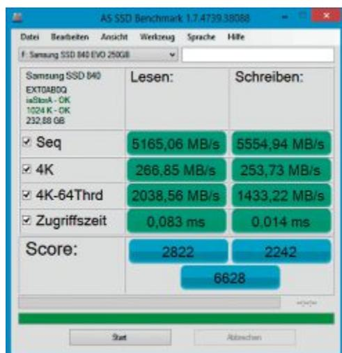
**Software-Cache in Aktion:** Die sequenziellen Datenraten klettern bei dieser beschleunigten SSD auf über 5 GByte/s beim Lesen und Schreiben (Bild C)
