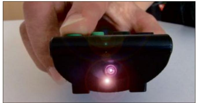
**Tipp 1 – Fernbedienung prüfen:** Das Infrarot-Signal von Fernbedienungen lässt sich mit einem Kamera-Display sichtbar machen und überprüfen
