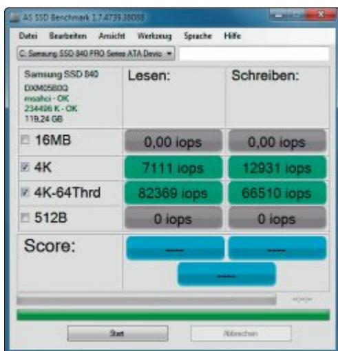
**IOPS-Werte:** Mit AS SSD Benchmark 1.7 lassen sich die IOPS-Werte einer eingebauten SSD testen – hier einer Samsung-SSD 840 Pro (Bild F)
