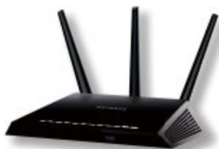
**802.11ac:** Der neue WLAN-Standard beschleunigt den Datenverkehr erheblich.
