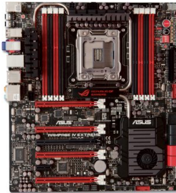
Mainboard: Dieses Mainboard hat den Formfaktor E-ATX und ist deshalb etwas breiter. Das bietet Platz für besonders viel Ausstattung (Bild A)
