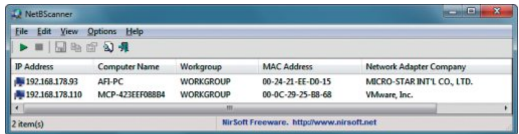
NetB Scanner 1.0: Das Netzwerk-Tool spürt alle Rechner im lokalen Netz auf und verwendet dabei eine NetBIOS-Suche, die nicht durch die Windows-Firewall blockiert wird (Bild C)
