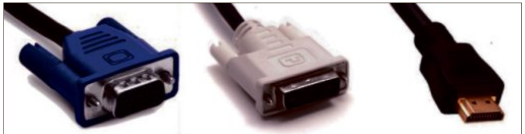
TV als PC-Bildschirm: Für den Anschluss des PCs an einen Fernseher wählen Sie anstelle eines VGA-Kabels (links) am besten eine DVI-Verbindung (Mitte) oder noch besser eine HDMI-Verbindung (rechts) (Bild D)
