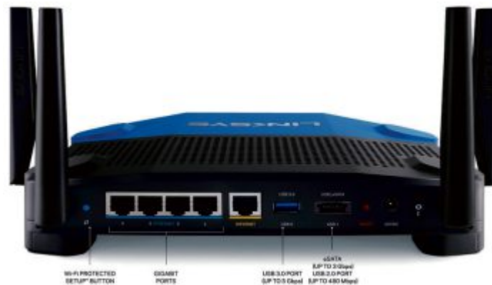
Router für ac-WLAN: Der Linksys WRT1900 AC arbeitet nach dem Standard 802.11ac und funkt mit vier Antennen.
