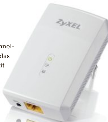
ZyXEL PLA5206: Überträgt Daten über das heimische Stromnetz.
