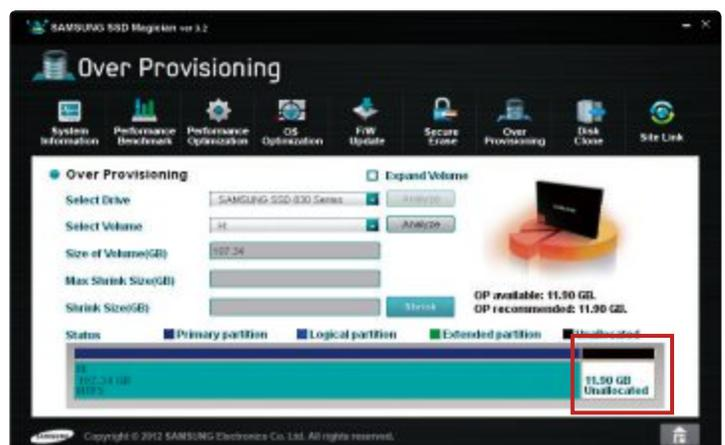
**Spare Area:** Der Reservespeicher einer SSD ist nur dem Controller zugänglich. Er dient als Ruheplatz für abgenutzte Speicherzellen und der Geschwindigkeitssteigerung (Bild I)
